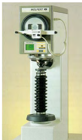
شکل ۵. دستگاه سختی سنج ویکرز
