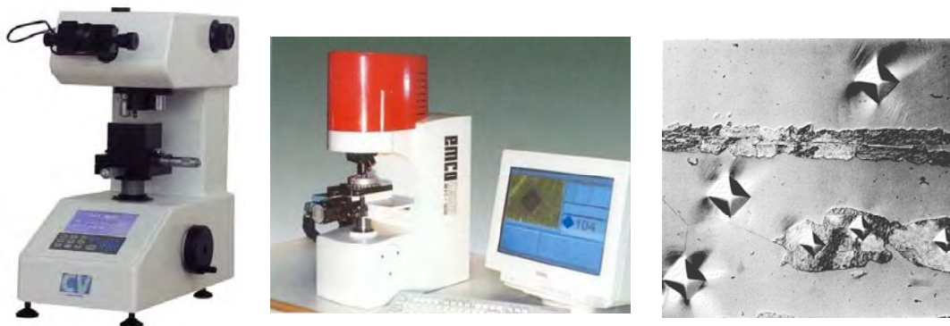
شکل ۹. تصویر چپ و وسط دو نمونه دستگاه سختی سنج میکرو و تصویر راست اثر فرورونده با نیروی ۱۰۰ گرم را روی فولاد زنگ نزن ۴۳۰ (از نوع پرکربن) نشان می دهد. نواحی روشن فاز آلفا و نواحی تیره رنگ، مارتنزیت هستند.
