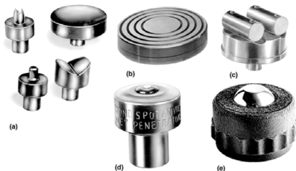
شکل ۸. انواع نگهدارنده ها برای سختی سنجی ماکرو نمونه های خاص و استفاده از یکی از آنها (نگهدارنده V) برای سختی سنجی شفت
