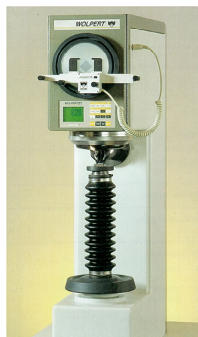
شکل 5. دستگاه سختی سنج ویکرز
