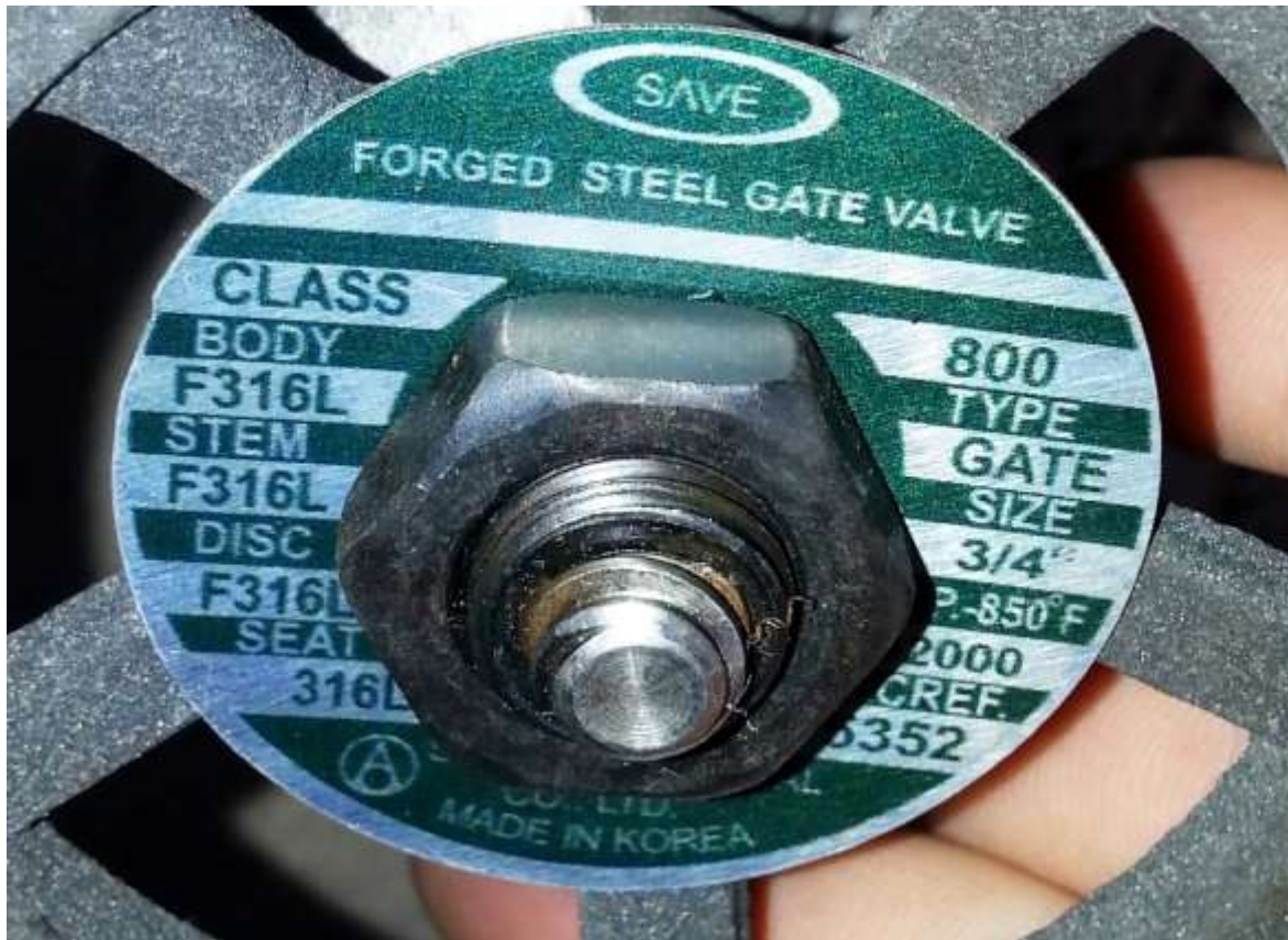
پلاک جعلی بر روی شیر بسته شده
