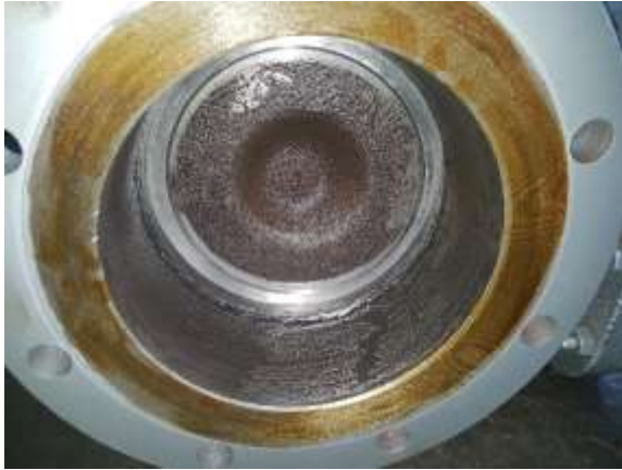
تست فشار بالای مجرابند High Pressure Closure Test در هر دو سمت seat راست و seat چپ با سیال آب انجام می شود .
