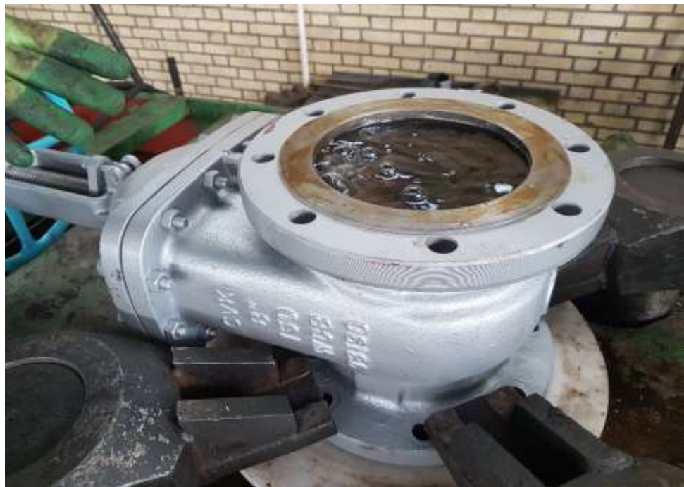
تست فشار پایین مجرابند Low Pressure Closure Test نمونه نشستی که به صورت حباب دیده می شود شیر بسته است و از پایین فشار هوا اعمال می شود . سمت بالا آب ریخته شده تا در صورت نشستی هوا حباب رویت شود .
