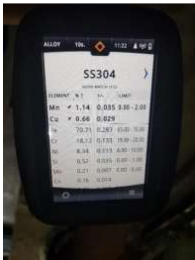
نمونه فلزی همراه دستگاه جهت بررسی دقت کالیبره بودن دستگاه
