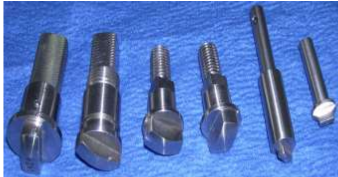
چند نوع ساقه برای شیرها با طراحی متفاوت
