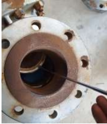
بررسی وضعیت فولاد زنگ نزن ۳۱۶ مورد استفاده در STEM و لبه دیسک
