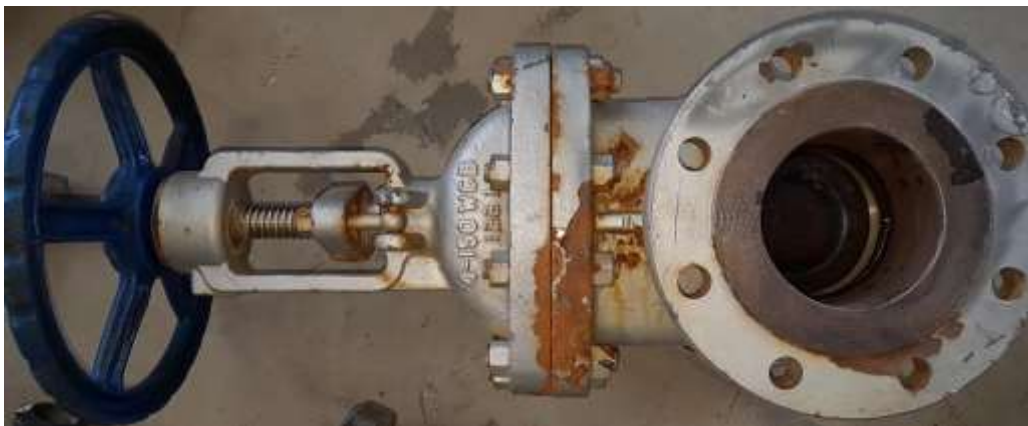
شیر کاملاً بسته و داخل آن آب ریخته شد
