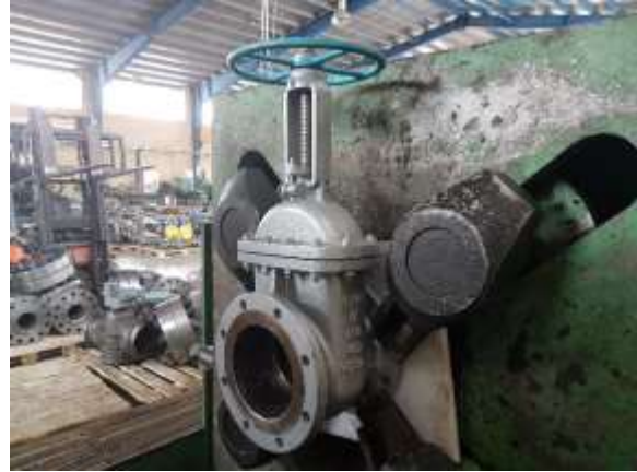
تست فشار بالای مجرابند High Pressure Closure Test در هر دو سمت seat راست و seat چپ با سیال آب انجام می شود .
