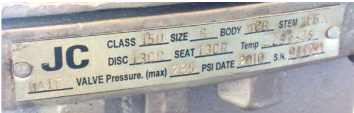
پلاک عوض شده مطابق مارکینگ روی شیر که با جوشکاری عوض شده
