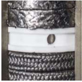
نحوه قرار گیری بین پکینگ ها
