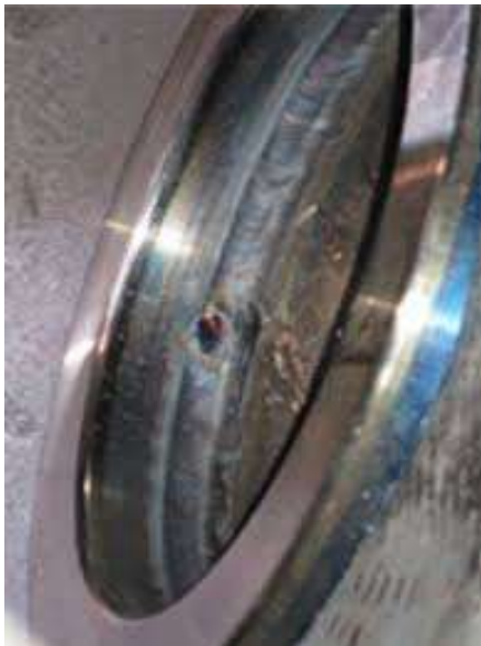
نشیمنگاه Seat بعد از مونتاژ - نوع جوشی (Welded)
