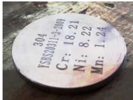
نمونه فلزی همراه دستگاه جهت بررسی دقت کالیبره بودن دستگاه
