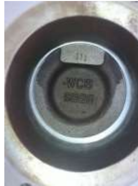
نمونه ای از مارکینگ روی دیسک شیر KITZ چینی
