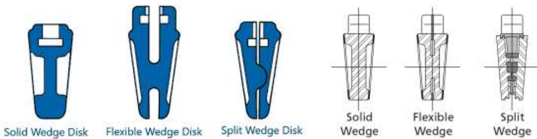
۱-۲-۳ انواع Wedge Gate دیسک گوه ای شکل
