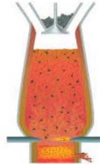
ب) گرما دادن مخلوط سنگ آهن، کربن و سنگ آهک س) تولید ورقه‌های فلز آهن در کوره
