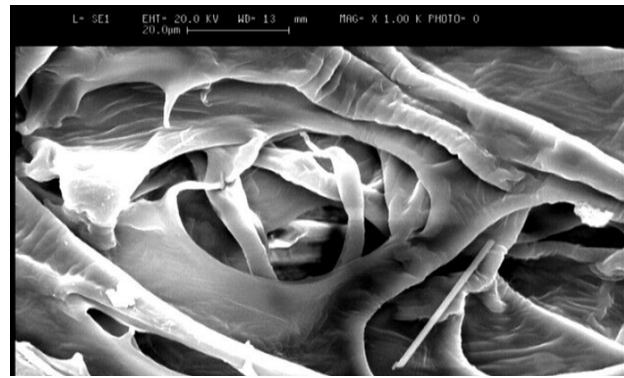
شکل ۶ تصویر SEM از سطح پوست لیمو با بزرگنمایی ۱۰۰۰ برابر
